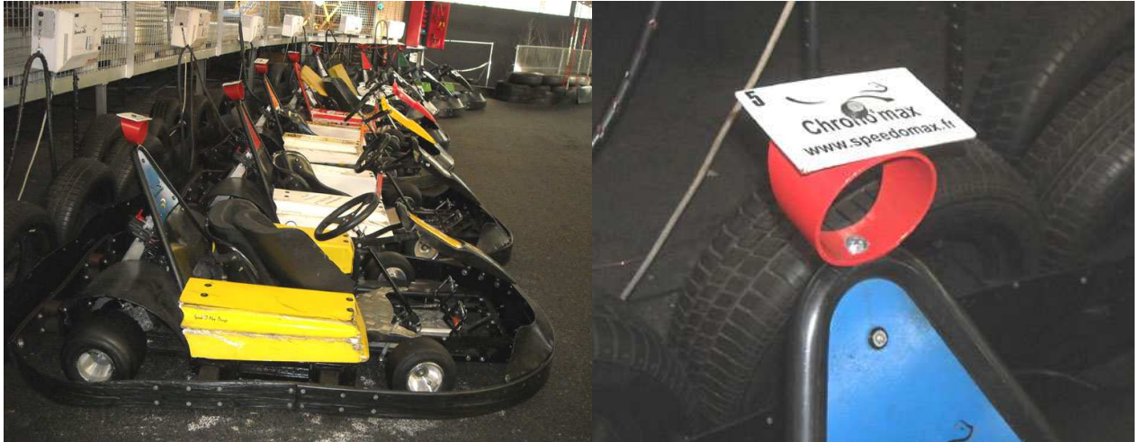
Figure. Exemple de fixation sur un kart SPEEDOMAX et plaque RFID ChronoMax (en rouge, un tuyau de PVC de 100 mm !).
