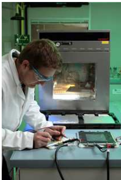
Laboratoire de stockage de l'énergie - Tests de cyclage d'une batterie lithium ions © P.Avavian/CEA
