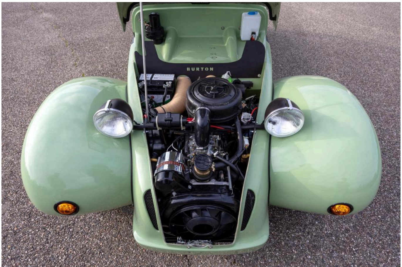
Sous le capot de la Burton thermique se niche un bicylindres de 602 cm 3 . Ben Brillante - L'argus
